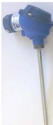
ж) термопреобразователь сопротивления ВЗЛЁТ ТПС
