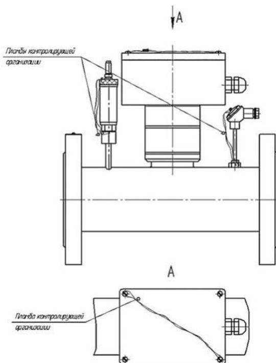
б) пломбирование расходомера «Ирга-РВС» с датчиками температуры и давления
